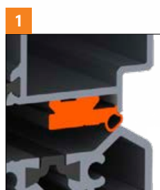
LE JOINT SUPPLÉMENTAIRE EPDM ASSURE UNE ÉTANCHÉITÉ ENTRE LE VANTAIL ET LE SEUIL.
