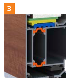
PROFILÉ TROIS CHAMBRES DE PROFONDEUR DE 60 MM AVEC INTERCALAIRES THERMIQUES
