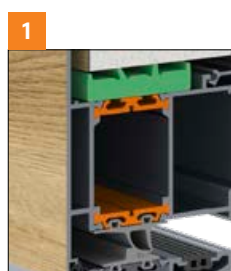
PROFILÉS À TROIS CHAMBRES DE PROFONDEUR DE 77 MM AVEC INTERCALAIRES THERMIQUES
